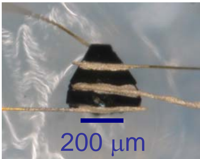
Mesure de résistance électrique d'un monocristal Résultats de la mesure
