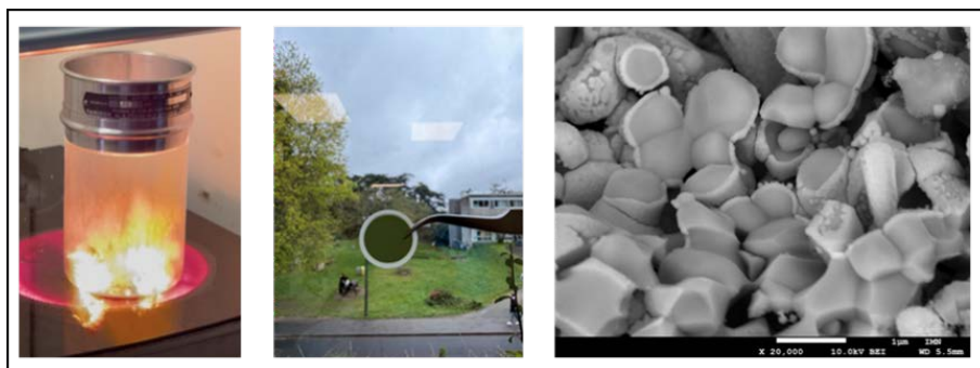
De gauche à droite : propagation de la flamme d'autocombustion lors de la synthèse des matériaux - cellule symétrique ayant pour électrode le cermet Ni/YSZ prête pour l'infiltration - phase infiltrée dans le squelette Ni/YSZ observée par MEB
